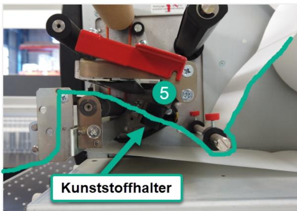
**3** neue Rolle einsetzen und das Etikettenband durch die beiden Kunststoffhalter (5) führen. Das Etikettenband wie oben dargestellt durchführen.
