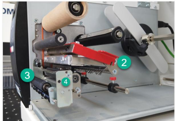
**2** den roten Hebel (2) gegen den Uhrzeigersinn öffnen. Die schwarze Riffelrolle (3) mittig festhalten und nach links schieben. Diese löst sich dann aus dem Arretierungsloch (4) und klappt nach vorne auf.
