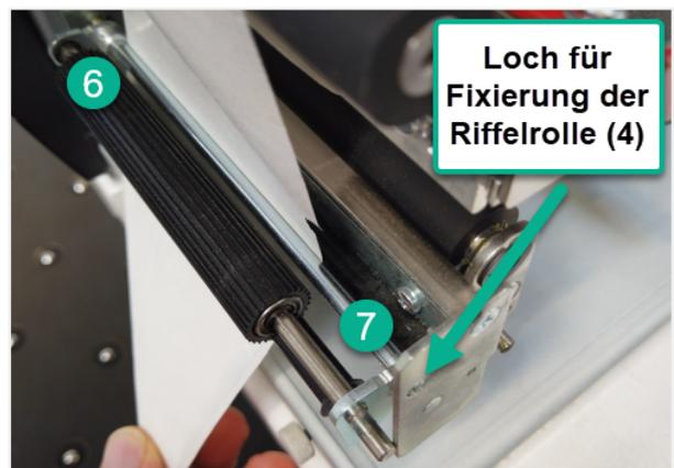
**4** Das nach vorne geführte Etikettenband senkrecht hinter der geriffelten Rolle (6) und hinter die Metallstange (7) führen. Danach die Rolle (6) wieder nach links ziehen und im Loch fixieren.
